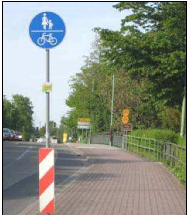
Bild 4-6: Gemeinsamer Geh- und Radweg
